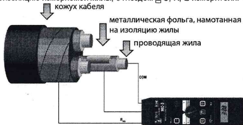
Рис.8. Измерение активного сопротивления электроизоляции кабеля методом трёх зажимов
