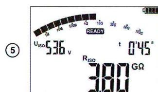
После окончания измерения на дисплее отобразится величина измерения сопротивления изоляции.
