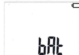
Аккумуляторы/батареи полностью разряжены.
