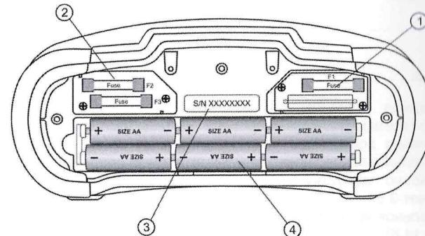
Рисунок 3.4: Батарейный отсек и отсек с плавкими предохранителями
