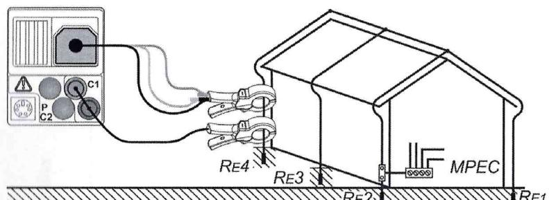
Рисунок 5.39: Бесконтактное измерение сопротивления заземления
