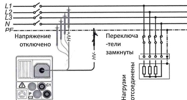
Рисунок 5.7: Подключение 2.5 кВ тестового кабеля) ( $U_{N} = 2.5 \text{ кВ}$ )
