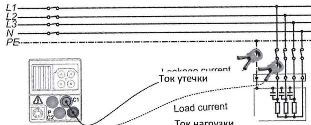
Рисунок 5.51: Измерения тока утечки и тока нагрузки
