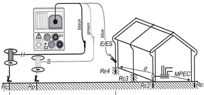
Рисунок 5.37: Сопротивление заземления, измерение сопротивления системы молниезащиты
