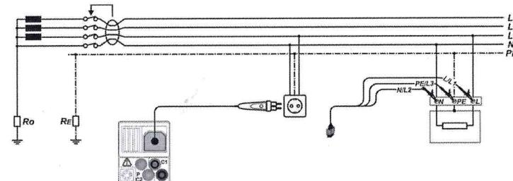
Рисунок 5.20: Подключение штепсельного щупа «plug commander» и 3-х проводного тестового кабеля
