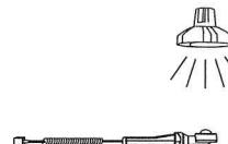
Рисунок 5.57: Позиционирование щупа люксметра
