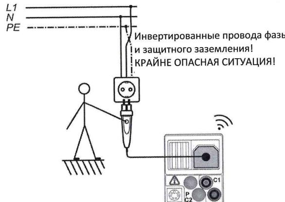
Рисунок 5.43: Инвертированные провода фазы и защитного заземления (L и PE) (щуп типа коммандер с вилкой (plug commander))
