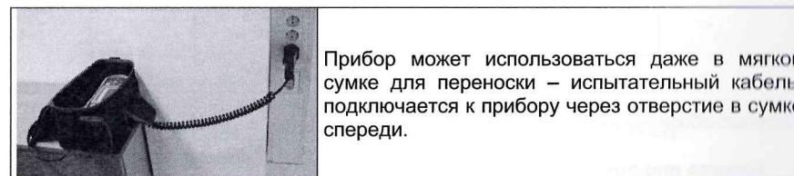
Прибор может использоваться даже в мягкой сумке для переноски – испытательный кабель, подключается к прибору через отверстие в сумке спереди.
