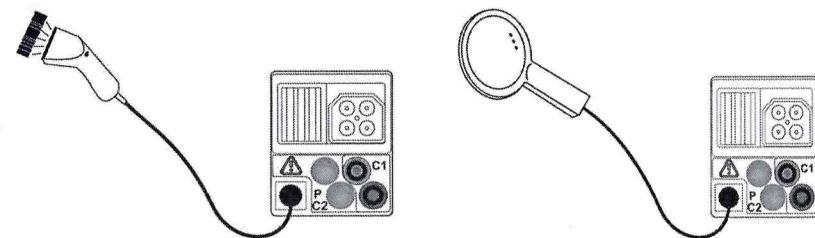
Рисунок 7.13: Подключение считывателя штрих-кодов и считывателя радиометок RFID
