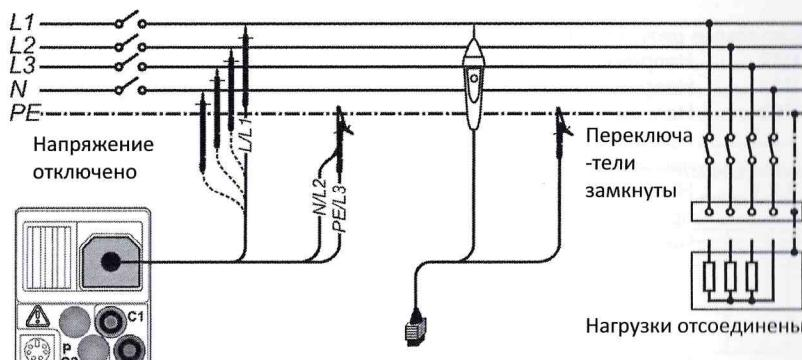
Рисунок 5.6: Подключение 3-х проводного тестового кабеля и щупа с наконечником «Tip commander» ( $U_{N} \leq 1 \text{ кВ}$ )
