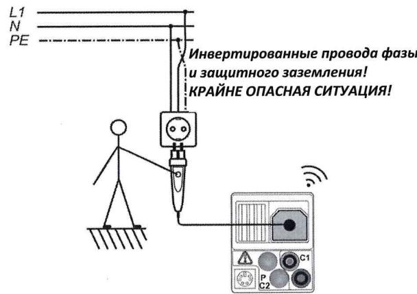
Рисунок С.4: Инвертированные проводники L и PE
